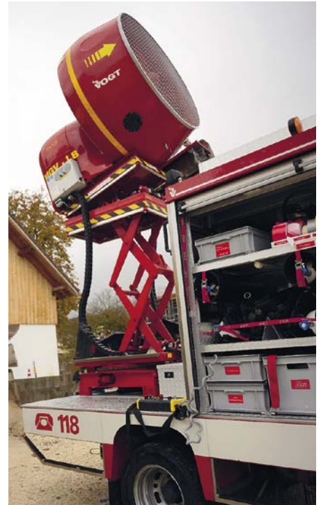
Der mobile Grossventilator (MGV) der Feuerwehr Langenthal.
